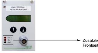
Zusätzliche Analogausgänge sind an der Frontseite eines jeden Messmoduls verfügbar.
